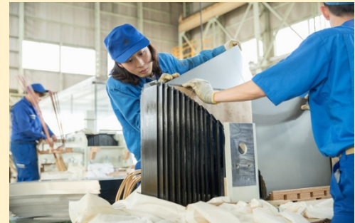
変圧器の中身を組み立てています。
